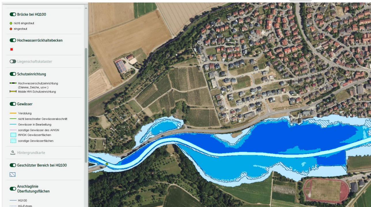
Abb. 6: Hochwassergefahrenkarte (Quelle LUBW 2025)
